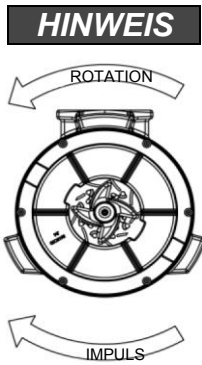
Fig. D – Ordnungsgemäße Rotation des Antriebsrads
